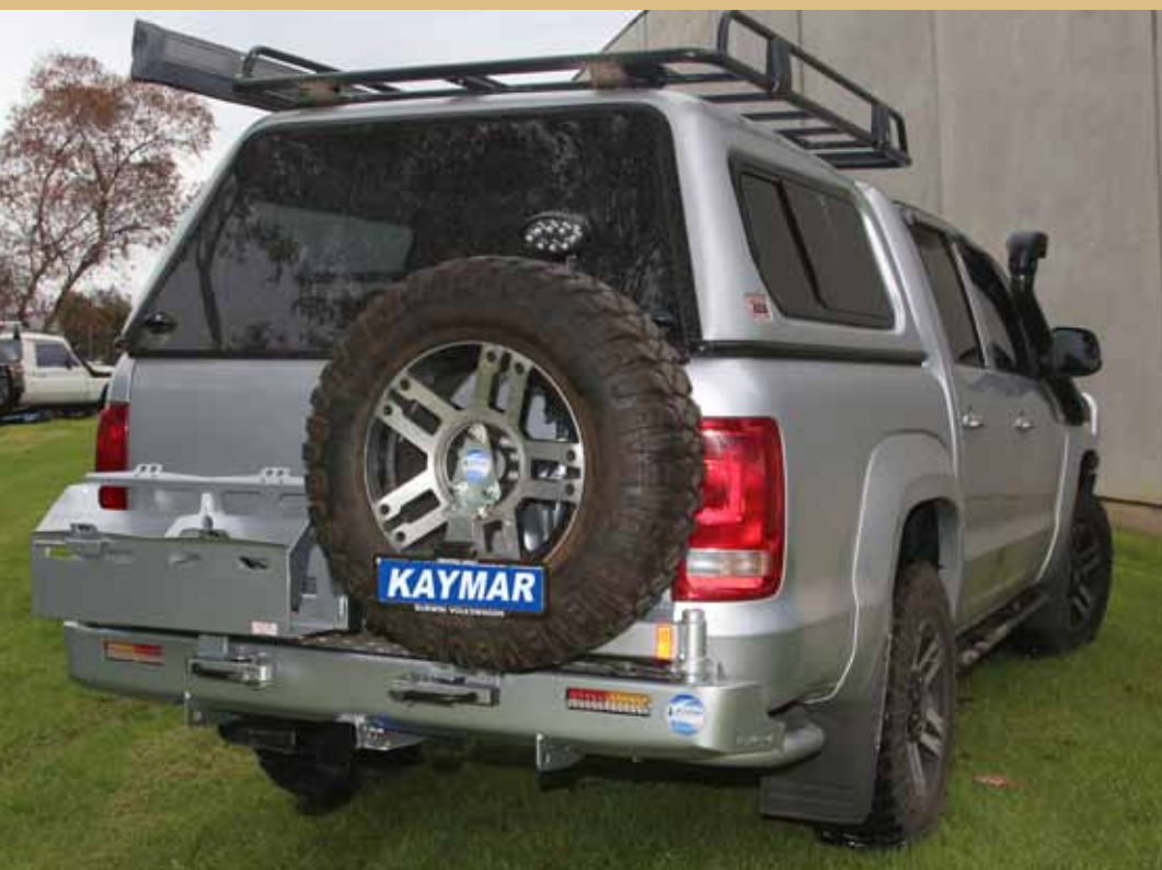
На задний бампер можно установить крепёж запасного колеса, буксировочные крюки, кассету для канистры и многое другое
