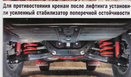
Регулируемые амортизаторы позволяют настраивать комфортную жесткость новой подвески
