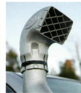
Благодаря шноркелю имеется возможность преодолевать водяные преграды, не опасаясь получить гидроудар
