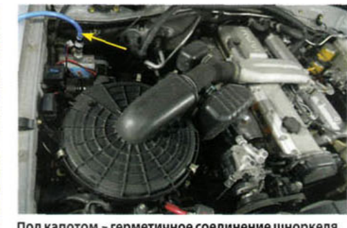
Под капотом – герметичное соединение шноркеля и воздушного фильтра и компрессор блокировок дифференциалов, который также можно использовать для подкачки шин через отдельный шланг (показан стрелкой)
