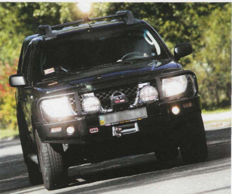
В помощь стандартной головной оптике установлены дополнительные фары. Фара-искатель управляет дистанционно – через электропривод
