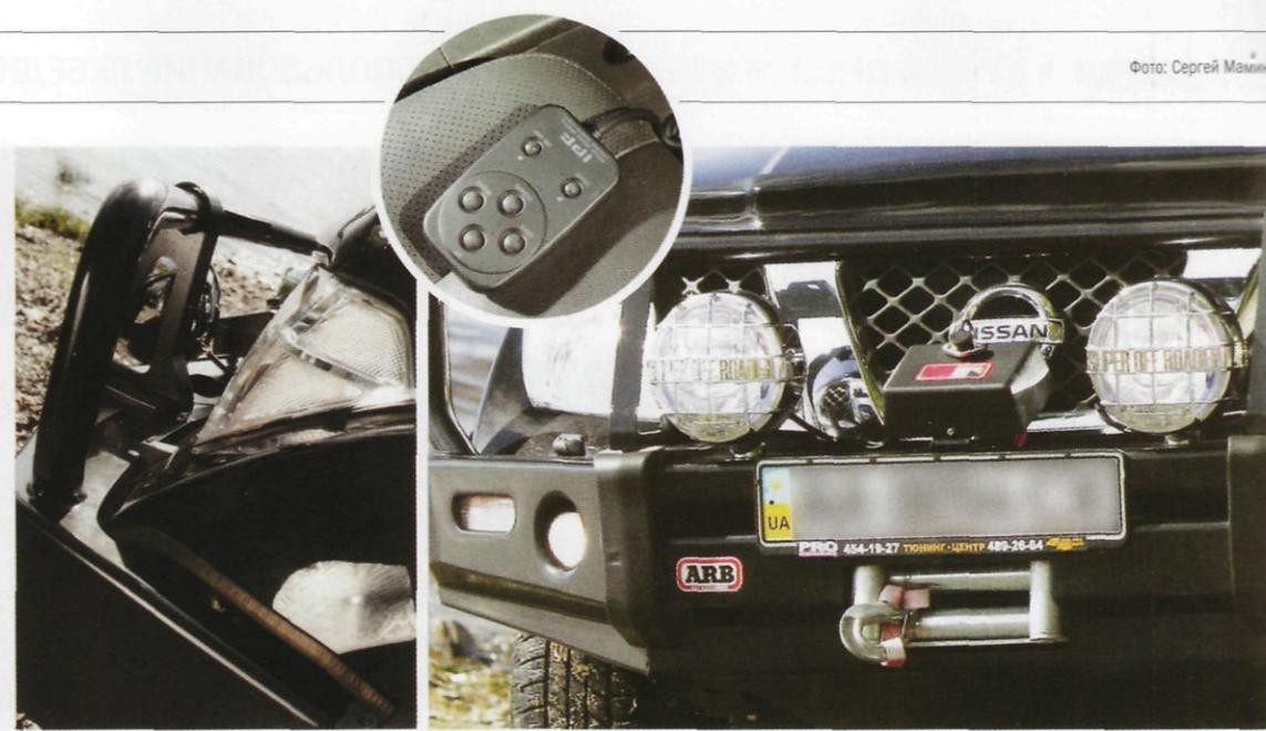
Интегрированная в передний бампер лебедка позволяет без особых усилий вытащить автомобиль из грязи. Находящийся в салоне пульт дистанционного управления (фото вверху) управляет фарой-искателем на крыше
