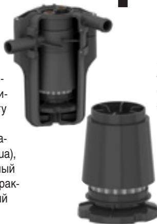
разборный корпус с поворачивающимся выходным штуцером, благодаря чему на фильтре можно выставить любые углы входа/выхода. Это очень удобно при монтаже в моторных отсеках разных марок и моделей авто. В этом фильтре есть специальный завихритель потока газа, что позволяет сепарировать масло, которое собирается в отстойнике. На
