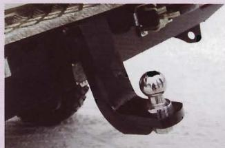
Бампер кормовой части подбирается под индивидуальные требования. На платформе органично разместятся носители запасного колеса и канистр, а тягово-сцепное устройство при необходимости можно снять
