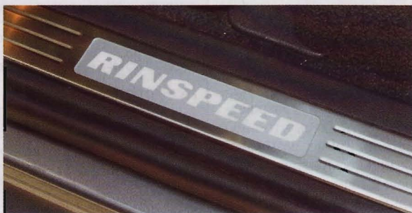
В пороги интегрированы алюминиевые вставки с логотипом Rinspeed, который подсвечивается изнутри
