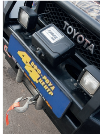
Бампер ARB служит платформой для лебедки TAVOR и дополнительной оптики
