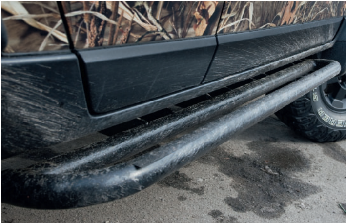
Установленные по бокам подножки не только облегчают посадку в высокий полноприводник, но и защищают нижнюю часть кузова от повреждений
