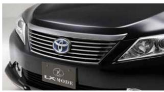
Решетка радиатора состоит из двух отдельных элементов и может быть дополнена логотипом Toyota, который легко устанавливается и снимается
