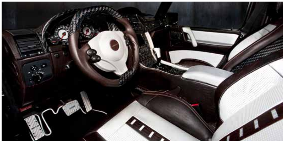
Средняя консоль по-новому оформлена, весь кокпит выполнен из карбона. Сиденья – эксклюзивная разработка Mansory с новой набивкой и кожаной отделкой, улучшающими эргономику, силовой рамой и «ковшами» из автоклавного карбона. Внизу: множество деталей SLR обеспечивают двигателю 700 сил и 880 Нм
