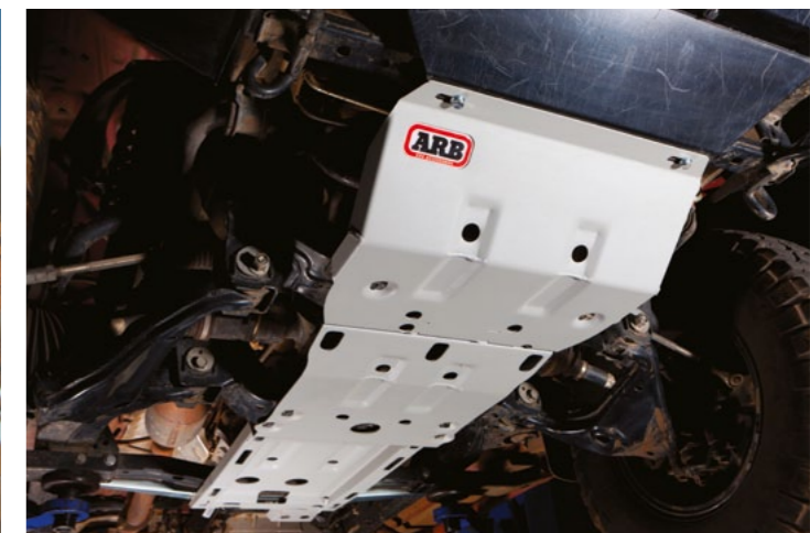
Для внедорожника одной из важнейших деталей является надежная защита двигателя и раздаточной коробки. Hilux'у не страшны любые камни
