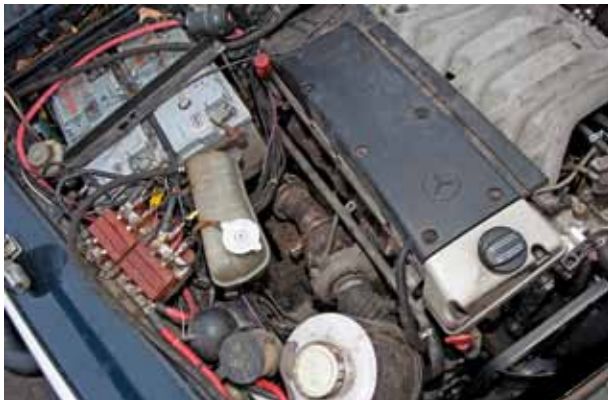
Родной атмосферный двигатель заменен на 3-литровый турбодизель. Два аккумулятора снабжают всю систему электричеством
