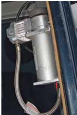
Компрессор установлен на стойке в багажном отсеке
