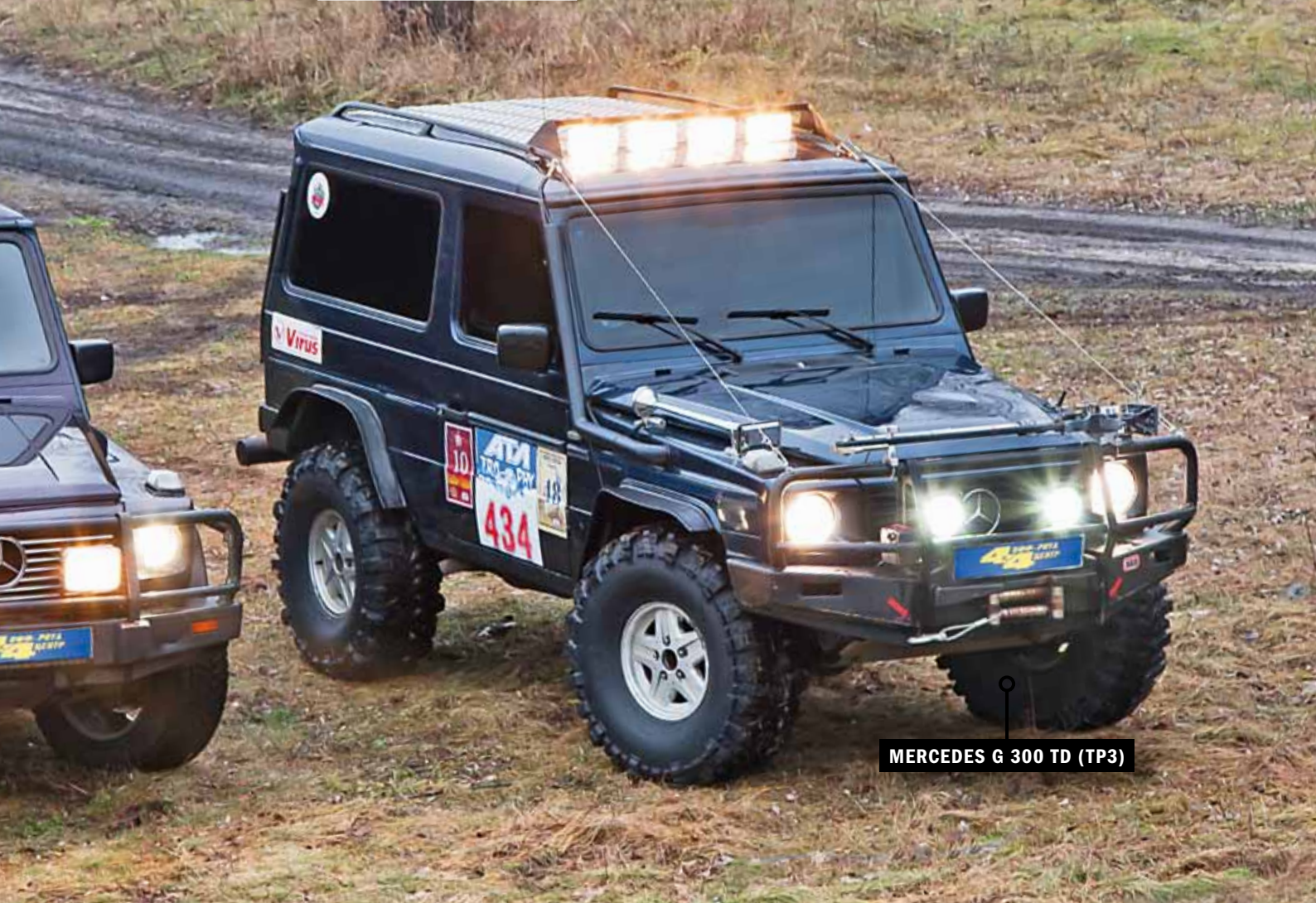
Силовой обвес по всему периметру и модернизированная подвеска. Передний бампер служит платформой для лебедки и дополнительной оптики
