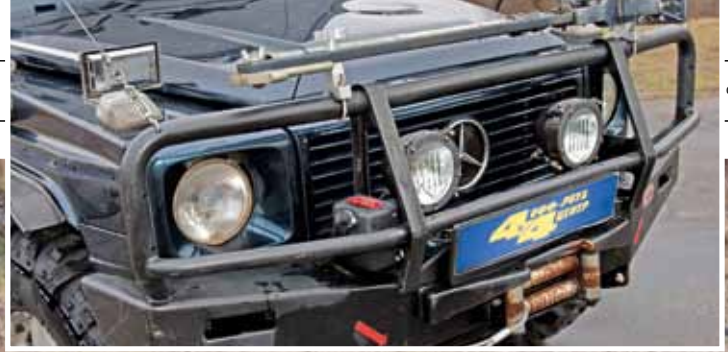
Силовой обвес по всему периметру и модернизированная подвеска. Передний бампер служит платформой для лебедки и дополнительной оптики
