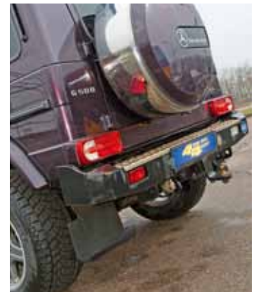
Минимум изменений: сзади установлен лишь силовой бампер и фаркоп
