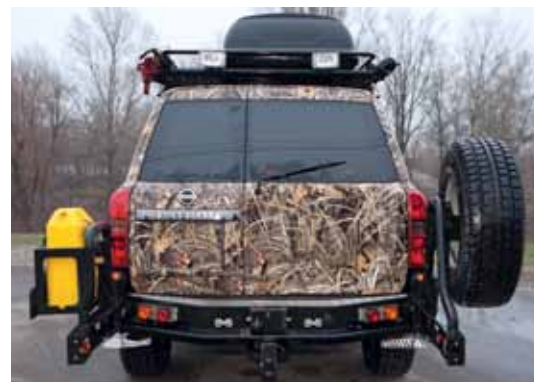
Тяжелая заправка теперь не разбивает петли задней двери и надежно закреплена на выносном крепеже
