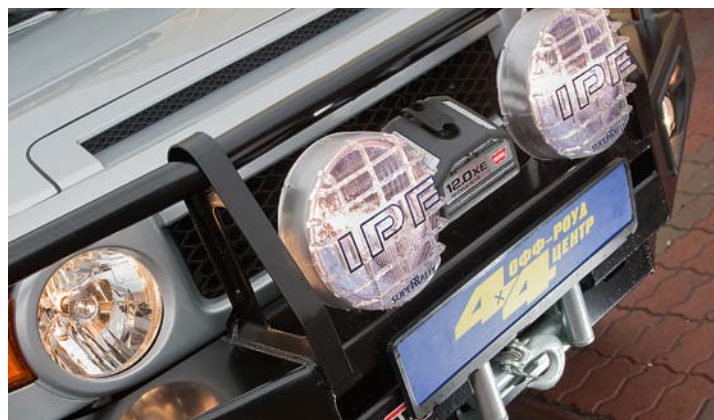
В бампер интегрирована лебедка с воздушным охлаждением. Воздух, нагнетаемый в корпус с помощью компрессора, защищает ее от влаги, а значит, она незаменима при преодолении глубоких водных преград
