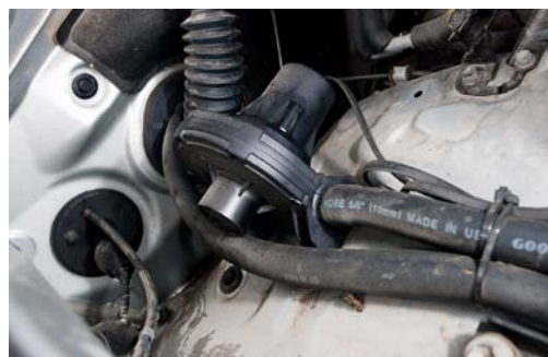
К водным процедурам готов! Выносной воздухозаборник позволяет с легкостью преодолевать даже самые глубокие броды
