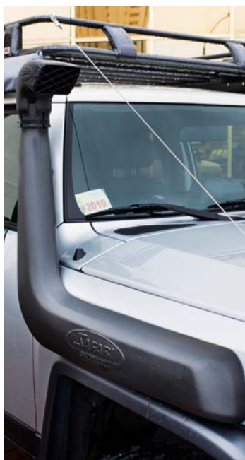
К водным процедурам готов! Выносной воздухозаборник позволяет с легкостью преодолевать даже самые глубокие броды
