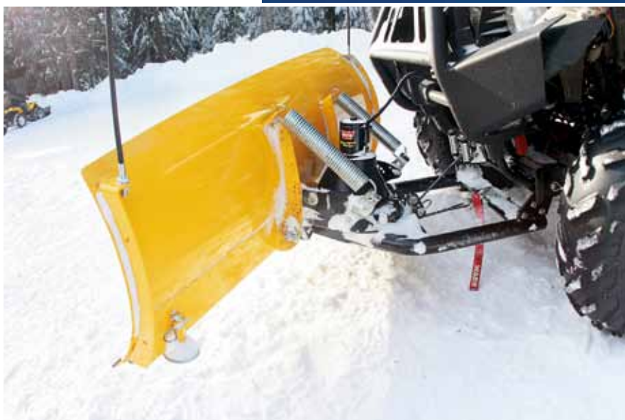
Незаменимый помощник для уборки снега: такой полезный в хозяйстве аксессуар легко монтируется на квадроцикл, оборудованный лебедкой
