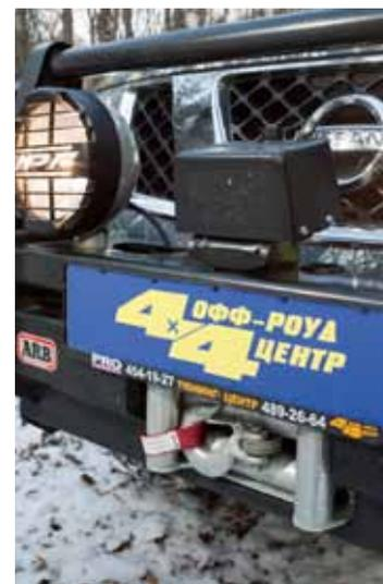
красочное покрытие не лучший вариант в лесу. Специальная матовая пленка, которой оклеивается весь автомобиль, не только делает его неприметным за пределами дороги, но и защищает кузов от царапин. Внедорожный обвес выполняет роль носителя для дополнительной оптики, лебедки или фаркопа, а также служит надежной защитой для кузова при случайных столкновениях с преградами.
