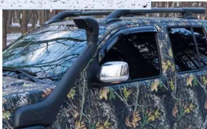
Выносной воздухосборник позволяет штурмовать очень глубокие водные преграды, не опасаясь гидроудара двигателя
