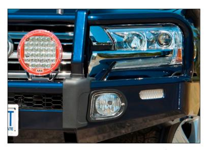
Вертикальная секция отбойника отлично сочетается с окантовкой противотуманной фары. Места пересечения стоек с полиуретановыми отбойниками закрываются специальными крышками, что придает бамперу аккуратный и завершенный вид.
